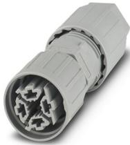
Connecteur, Raccordement QUICKON, 690 V, 20 A, gris, avec écrou QUICKON, diamètre extérieur du câble: 9 mm ... 14 mm
