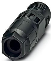
Prolongateur de câble, Raccordement QUICKON, nombre de pôles: 3+PE, 690 V, 20 A, noir, avec un écrou QUICKON, diamètre extérieur du câble: 6 mm ... 10 mm, Connecteur QUICKON
