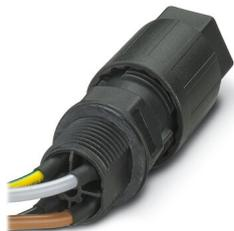
Traversée de paroi, Raccordement QUICKON, nombre de pôles: 3+PE, 690 V, 20 A, noir, avec écrou QUICKON, diamètre extérieur du câble: 6 mm ... 10 mm, filetage de montage: M25, Raccordement IDC (soudé), 2,5 mm<sup>2</sup>, fils coupés nets, longueur du câble: 1 m
