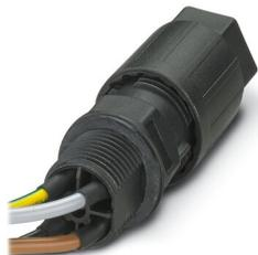
Traversée de paroi, Raccordement QUICKON, nombre de pôles: 3+PE, 690 V, 20 A, noir, avec écrou QUICKON, diamètre extérieur du câble: 6 mm ... 10 mm, filetage de montage: M25, Raccordement IDC (soudé), 2,5 mm<sup>2</sup>, fils coupés nets, longueur du câble: 0,5 m
