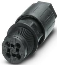
Traversée de paroi, Raccordement QUICKON, nombre de pôles: 3+PE, 400 V, 20 A, noir, avec écrou QUICKON, diamètre extérieur du câble: 6 mm ... 10 mm, filetage de montage: M25, Raccordement Push-in, 2,5 mm<sup>2</sup>
