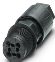
Traversée de paroi, Raccordement QUICKON, nombre de pôles: 3+PE, 400 V, 20 A, noir, avec écrou QUICKON, diamètre extérieur du câble: 9 mm ... 14 mm, filetage de montage: M25, Raccordement Push-in, 2,5 mm<sup>2</sup>
