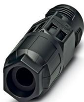
Prolongateur de câble, Raccordement QUICKON, nombre de pôles: 3+PE, 690 V, 20 A, noir, avec un écrou QUICKON, diamètre extérieur du câble: 9 mm ... 14 mm, Connecteur QUICKON
