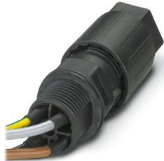
Traversée de paroi, Raccordement QUICKON, nombre de pôles: 3+PE, 690 V, 20 A, noir, avec écrou QUICKON, diamètre extérieur du câble: 9 mm ... 14 mm, filetage de montage: M25, Raccordement IDC (soudé), 2,5 mm<sup>2</sup>, fils coupés nets, longueur du câble: 0,5 m
