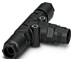
Répartiteur en T, Raccordement QUICKON, nombre de pôles: 3+PE, 690 V, 20 A, noir, avec deux écrous QUICKON, diamètre extérieur du câble: 9 mm ... 14 mm
