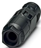
Prolongateur de câble, Raccordement QUICKON, nombre de pôles: 3+PE, 690 V, 20 A, noir, avec un écrou QUICKON, diamètre extérieur du câble: 9 mm ... 14 mm, Connecteur QUICKON
