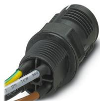
Traversée de paroi, Raccordement QUICKON, nombre de pôles: 3+PE, 690 V, 20 A, noir, sans écrou QUICKON, filetage de montage: M25, Raccordement IDC (soudé), 2,5 mm<sup>2</sup>, fils coupés nets, longueur du câble: 0,5 m
