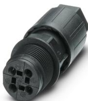
Traversée de paroi, Raccordement QUICKON, nombre de pôles: 3+PE, 400 V, 20 A, noir, avec écrou QUICKON, diamètre extérieur du câble: 9 mm ... 14 mm, filetage de montage: M25, Raccordement Push-in, 2,5 mm<sup>2</sup>
