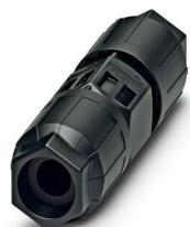
Prolongateur de câble, Raccordement QUICKON, nombre de pôles: 3+PE, 690 V, 20 A, noir, avec deux écrous QUICKON, diamètre extérieur du câble: 9 mm ... 14 mm, Connecteur QUICKON
