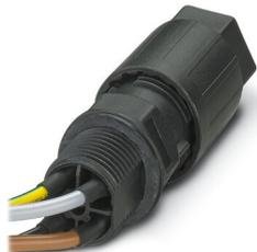
Traversée de paroi, Raccordement QUICKON, nombre de pôles: 3+PE, 690 V, 20 A, noir, avec écrou QUICKON, diamètre extérieur du câble: 9 mm ... 14 mm, filetage de montage: M25, Raccordement IDC (soudé), 2,5 mm<sup>2</sup>, fils coupés nets, longueur du câble: 1 m
