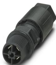
Traversée de paroi, Raccordement QUICKON, nombre de pôles: 3+PE, 690 V, 20 A, noir, avec écrou QUICKON, diamètre extérieur du câble: 9 mm ... 14 mm, filetage de montage: M25, Raccordement par clips, 2,5 mm<sup>2</sup>
