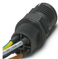
Traversée de paroi, Raccordement QUICKON, nombre de pôles: 3+PE, 690 V, 20 A, noir, sans écrou QUICKON, filetage de montage: M25, Raccordement IDC (soudé), 2,5 mm<sup>2</sup>, fils coupés nets, longueur du câble: 1 m
