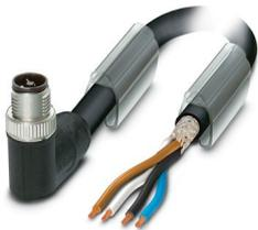
Conducteur de puissance, 4-pôles exempt d'halogène, blindé (Advanced Shielding Technology), connecteur mâle coudé M12, détrompage: T, sur extrémité libre, longueur de câble: 5 m, pour courant continu jusqu'à 12 A/63 V
