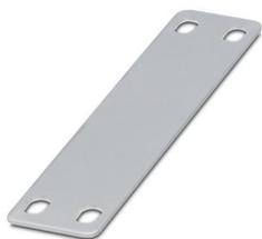
Repères pour câble, Planche d'aluminium, coloris alu, vierge, repérable avec : BLUEMARK ID COLOR, BLUEMARK ID, BLUEMARK CLED, type de montage: Montage avec collier serrant, diamètre du câble: > 4,6 mm, surface utile: 60 x 15 mm
