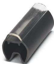
Repères pour fils, transparent/noir, vierge, type de montage: enfilage, plage de diamètre de câble: 4 ... 7 mm, surface utile: 23 x 4 mm
