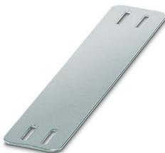
Repères pour câble, Planche d'aluminium, coloris alu, vierge, repérable avec : BLUEMARK ID COLOR, BLUEMARK ID, BLUEMARK CLED, type de montage: Montage avec collier serrant, diamètre du câble: > 4,6 mm, surface utile: 40 x 15 mm
