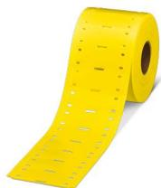
Repères pour câble, Rouleau, jaune, vierge, repérable avec : THERMOMARK E. 300 (D)/600 (D), THERMOMARK ROLL 2.0, THERMOMARK ROLL, THERMOMARK ROLL X1, THERMOMARK ROLLMASTER 300/600, THERMOMARK X1.2, type de montage: Montage avec collier serrant, diamètre du câble:  $\geq 6$  mm, surface utile: 55 x 25 mm, Nombre d'étiquettes: 500
