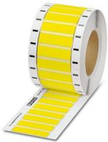
Gaine thermorétractable, Rouleau, jaune, vierge, repérable avec : THERMOMARK E.300 (D)/600 (D), THERMOMARK ROLLMASTER 300/600, THERMOMARK ROLL X1, THERMOMARK ROLL, THERMOMARK ROLL 2.0, THERMOMARK W, THERMOMARK X1.2, non perforé, type de montage: enfilage, plage de diamètre de câble: 4,8 ... 9,5 mm, surface utile: 60 x 16 mm, Nombre d'étiquettes: 500
