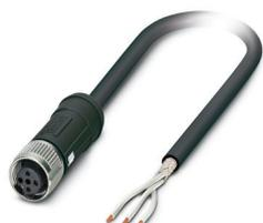
Câble pour capteurs/actionneurs, 3-pôles exempt d'halogène, blindé, extrémité libre, sur Connecteur femelle droit M12 SPEEDCONNEC, détrompage: A, longueur de câble: 2,5 m, pour application ferroviaires
