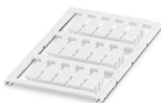
Repérage des conducteur, Planche, blanc, vierge, repérable avec : TOPMARK NEO, LASER TOPMARK, BLUEMARK ID COLOR, BLUEMARK ID, BLUEMARK CLED, THERMOMARK PRIME, THERMOMARK CARD 2.0, THERMOMARK CARD, type de montage: clipsage, plage de diamètre de câble: 6,8 ... 7,5 mm, surface utile: 23 x 8 mm, Nombre d'étiquettes: 15
