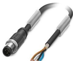
Câble pour capteurs/actionneurs, 4-pôles exempt d'halogène, blindé (Advanced Shielding Technology), connecteur mâle droit M12, détrompage: A, câblé avec déconnecté, sur extrémité libre, longueur de câble: 1 m
