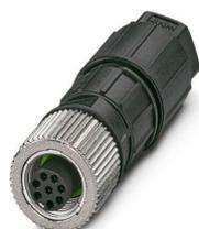
Connecteur, Universel, 8-pôles, connecteur femelle droit M12, détrompage: A, Raccordement autodénudant, matériau de la molette: Zinc moulé sous pression, nickelé, diamètre extérieur du câble 3 mm ... 7 mm
