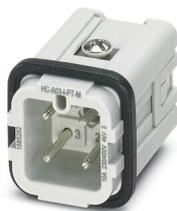
Élément de contact, nombre de pôles: 3+PE, taille: D7, nombre de raccordements par pôle: 1, Mâle, Raccordement Push-in, 230 V/400 V, 10 A, 0,14 mm<sup>2</sup> ... 1,5 mm<sup>2</sup>
