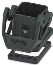
Embase D7, avec étrier longitudinal, matériau: PA, hauteur: 25,5 mm, presse-étoupe: sans, Standard
