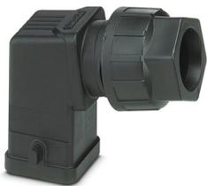
Capot passe-câble D7, pour étrier longitudinal, matériau: PA, nombre de sorties: 1, latérale, M20, hauteur: 54,5 mm, presse-étoupe: avec, Standard
