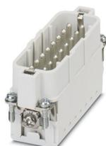
Élément de contact, nombre de pôles: 16+PE, taille: D25, nombre de raccordements par pôle: 1, Mâle, Raccordement Push-in, 250 V, 16 A, 0,14 mm<sup>2</sup> ... 2,5 mm<sup>2</sup>
