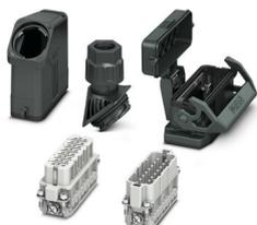
Jeu de connecteurs, nombre de pôles: 16, matériau: PA, type de raccordement: Raccordement Push-in, section raccordable: AWG 26- 14
