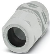
Presse-étoupe, matériau du raccordement vissé: PA, diamètre extérieur du câble 16 mm ... 28 mm, blindage: non, filetage de raccordement: M40 x 1,5, coloris: gris clair RAL 7035
