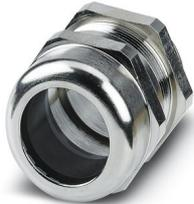
Presse-étoupe, matériau du raccordement vissé: Laiton, nickelé, diamètre extérieur du câble 37 mm ... 53 mm, blindage: non, filetage de raccordement: M63 x 1,5, coloris: argenté, avec joint torique
