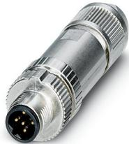
Connecteur de données, INTERBUS (500 kbit/s), 5-pôles, blindé, connecteur mâle droit M12, B, Raccordement à ressort Push-Lock, matériau de la molette: Zinc moulé sous pression, nickelé, diamètre extérieur du câble 4 mm ... 8 mm
