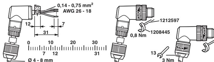
Glisser les écrous de pression et les capots passe-câble sur le câble, dénuder ce dernier, raccourcir le blindage, dénuder les fils, raccorder ces derniers, les torsader légèrement ensemble en cas de capot passe-câble droit, coller le film de blindage autour du blindage raccourci, coller un autre film de blindage autour du paquet de fils en cas de diamètre extérieur de câble < 6 mm, visser le capot passe-câble avec l'isolant mâle, visser fermement l'écrou de pression.
