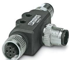
Répartiteur en T, PROFIBUS DP (12 Mbit/s), 5-pôles, blindé, Connecteur femelle droit M12, détrompage: B, sur connecteur mâle droit M12, détrompage: B et connecteur mâle droit M12, détrompage: B, Filetage M12 fixe à l'entrée du connecteur
