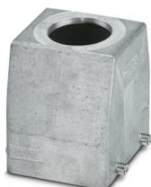
Capot passe-câble B32, pour étrier transversal, matériau: Aluminium coulé sous pression, résistant à l'eau de mer, nombre de sorties: 1, droit, 1x M50, hauteur: 94 mm, presse-étoupe: sans, Standard
