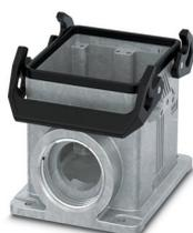
Embase en saillie B32, avec étrier transversal, matériau: Aluminium coulé sous pression, résistant à l'eau de mer, nombre de sorties: 2, latérale, 2x Pg29, hauteur: 90 mm, presse-étoupe: sans, Standard
