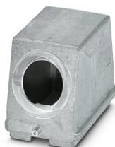
Capot passe-câble B48, pour étrier longitudinal, matériau: Aluminium coulé sous pression, résistant à l'eau de mer, nombre de sorties: 1, latérale, 1x M32, hauteur: 107,5 mm, presse-étoupe: sans, Standard
