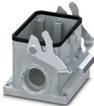
Embase en saillie B48, avec étrier longitudinal, matériau: Aluminium coulé sous pression, résistant à l'eau de mer, nombre de sorties: 2, latérale, 2x Pg29, hauteur: 99 mm, presse-étoupe: sans, Standard
