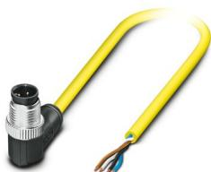
Câble pour capteurs/actionneurs, 4-pôles, PVC, jaune, connecteur mâle coudé M12, détrompage: A, sur extrémité libre, longueur de câble: 5 m
