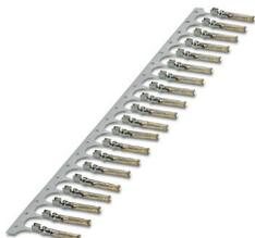
Contact à sertir, diamètre de contact: 1,6 mm, roulés, Connecteur femelle, matériau de contact: Alliage Cu, nickelé, surface des contacts: plaqué argent, section raccordable: 0,34 mm<sup>2</sup> ... 1 mm<sup>2</sup>, AWG 22 ... 17, Produits en bande
