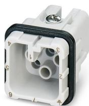
Élément de contact, nombre de pôles: 7+PE, taille: D7, Mâle, Raccordement à sertir, 42 V, 10 A, 0,14 mm<sup>2</sup> ... 2,5 mm<sup>2</sup>
