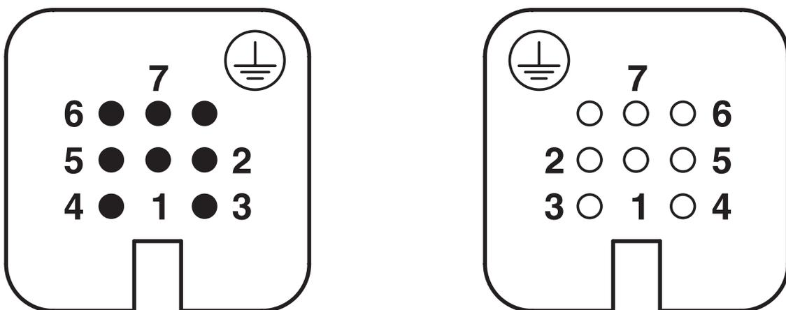
Brochage côté de raccordement : Connecteur mâle G, femelle D
