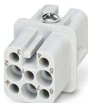
Élément de contact, nombre de pôles: 7+PE, taille: D7, Connecteur femelle, Raccordement à sertir, 42 V, 10 A, 0,14 mm<sup>2</sup> ... 2,5 mm<sup>2</sup>
