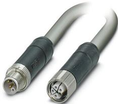
Conducteur de puissance, 5-pôles exempt d'halogène, connecteur mâle droit M12, détrompage: L, sur Connecteur femelle droit M12, détrompage: L, longueur de câble: 0,6 m, pour courant continu jusqu'à 12 A/63 V
