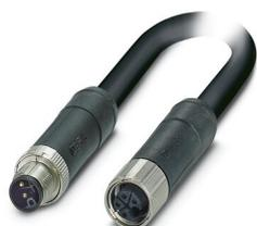
Conducteur de puissance, 4-pôles exempt d'halogène, connecteur mâle droit M12, détrompage: L, sur Connecteur femelle droit M12, détrompage: L, longueur de câble: 1,5 m, pour courant continu jusqu'à 12 A/63 V
