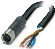
Conducteur de puissance, 4-pôles exempt d'halogène, extrémité libre, sur Connecteur femelle droit M12, détrompage: L, longueur de câble: 3 m, pour courant continu jusque 16 A / 63 V
