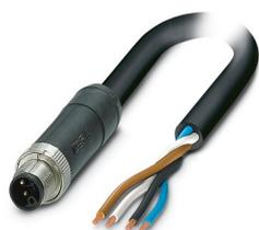
Conducteur de puissance, 4-pôles, connecteur mâle droit M12, détrompage: L, sur extrémité libre, longueur de câble: 1,5 m, pour courant continu jusque 16 A / 63 V
