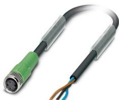
Câble pour capteurs/actionneurs, 3-pôles exempt d'halogène, extrémité libre, sur Connecteur femelle droit M8, détrompage: A, longueur de câble: 15 m
