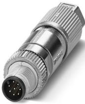
Connecteur de données, Ethernet CAT5 (1 Gbit/s), 8-pôles, exempt d'halogène, blindé, connecteur mâle droit M12, détrompage: A, Raccordement autodénudant, matériau de la molette: Zinc moulé sous pression, nickelé, diamètre extérieur du câble 5 mm ... 9,7 mm
