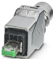
Connecteur RJ45, indice de protection: IP65/IP67, nombre de pôles: 8, 1 Gbit/s, CAT5, matériau: Métal, type de raccordement: Raccordement autodénudant IDC, section raccordable: AWG 26- 24, sortie du câble: droit, Ethernet
