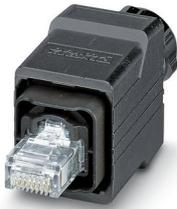
Connecteur RJ45, indice de protection: IP65/IP67, nombre de pôles: 8, 1 Gbit/s, CAT5 (CEI 11801:2002), matériau: Plastique, type de raccordement: Raccordement autodénudant IDC, section raccordable: AWG 26- 22, sortie du câble: droit, coloris: noir, Ethernet
