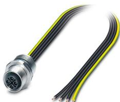
Embases paroi avant, Puissance, 4-pôles, connecteur femelle, droit, M12, détrompage: S, sur extrémité libre, Montage sur face avant, M16 x 1,5, Cordons individuels, Tresse de connexion UL/cUL, Produit de remplacement selon RoHS II sans exception 6c (Pb < 0,1 %) référence : 1239577
