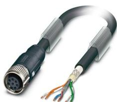
Câble préconfectionné pour bus, VARAN (100 Mbit/s), 6-pôles, blindé, extrémité libre, sur Connecteur femelle droit M12 SPEEDCONNEC, détrompage: A, longueur de câble: 2 m
