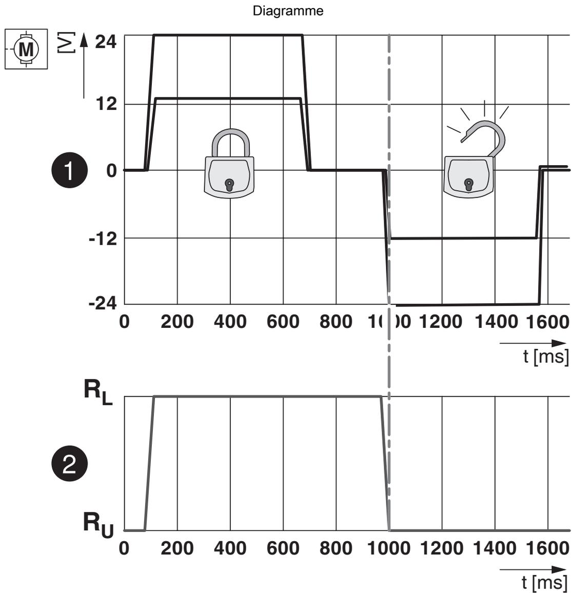
États de verrouillage de l'actionneur de verrouillage
