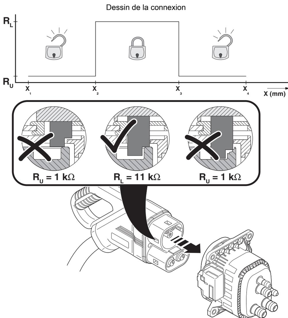
Détection pour connecteur mâle de véhicule
