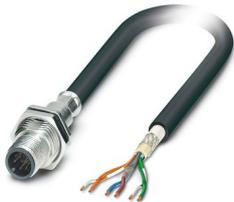
Connecteur d'appareil face arrière, 8-pôles, SANTOPRENE exempt d'halogène, noir RAL 9005, blindé, Connecteur mâle, droit, M12, détrompage: A, sur extrémité libre, Montage face arrière, M16 x 1,5, Raccordement de câble, longueur de câble: 5 m, 0,25 mm<sup>2</sup>, Produit de remplacement selon RoHS II sans exception 6c (Pb < 0,1 %) référence : 1239594
