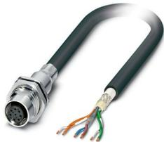
Connecteur d'appareil face arrière, 8-pôles, SANTOPRENE exempt d'halogène, noir RAL 9005, blindé, connecteur femelle, droit, M12, détrompage: A, sur extrémité libre, Montage face arrière, M16 x 1,5, Raccordement de câble, longueur de câble: 1 m, 0,25 mm<sup>2</sup>, Produit de remplacement selon RoHS II sans exception 6c (Pb < 0,1 %) référence : 1239596
