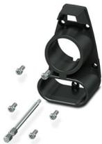
CHARX connect, Kit de réparation, Accessoires, avec cadre d'enchâssement échangeable, Avec 5 vis à tête plate M4X10 et à entraînement de sécurité Torx (IPR TORX PLUS® IPR®). Avec embout spécial (embout 867/4 IPR TORX PLUS®, 20 IPR x 89 mm) pour tournevis de sécurité, pour le changement du cadre d'enchâssement des connecteurs de charge côté véhicule, CCS type 1, CEI 62196-3-1, SAE J1772, Montage vissé, boîtiers: noir, Changement sans vidange du fluide de refroidissement
