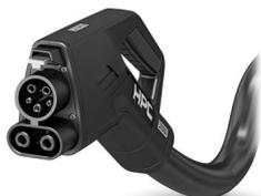
CHARX connect professional, Câble de charge DC HPC, avec connecteur de charge côté véhicule et câble refroidis, pour la charge en courant continu (DC) des véhicules électriques (VE), Avec support de connecteur de charge, avec cadre d'enchâssement échangeable, sans traversée de paroi, avec capteurs de température numériques, CCS type 1, SAE J1772, CEI 62196-3-1, 500 A / 1000 V (DC), Logo PHOENIX CONTACT, câble: 6 m, noir, droit
