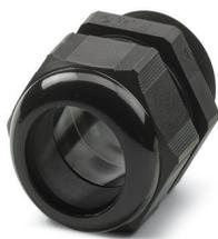
Presse-étoupe, matériau du raccordement vissé: PA, diamètre extérieur du câble 34 mm ... 44 mm, blindage: non, filetage de raccordement: M63 x 1,5, coloris: noir foncé RAL 9005
