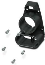
CHARX connect, Kit de réparation, Accessoires, avec cadre d'enfichage échangeable. Avec 5 vis à tête plate M4X10 et à entraînement de sécurité Torx (IPR TORX PLUS® IEC 60332-1) pour le changement du cadre d'enfichage des connecteurs de charge côté véhicule, CCS type 1, CEI 62196-3-1, SAE J1772, Montage vissé, boîtiers: noir, Changement sans vidange du fluide de refroidissement
