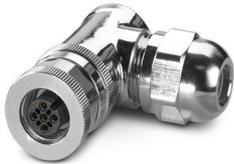
Connecteur, Universel, 5-pôles, blindé, connecteur femelle coudé M12, détrompage: A, Raccordement vissé, matériau de la molette: Laiton, nickelé, presse-étoupe Pg9, diamètre extérieur du câble 6 mm ... 8 mm
