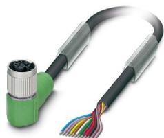
Câble pour capteurs/actionneurs, 12-pôles exempt d'halogène, extrémité libre, sur Connecteur femelle coudé M12 SPEEDCONNEC, détrompage: A, longueur de câble: 1,5 m
