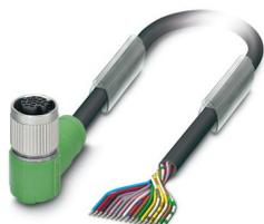
Câble pour capteurs/actionneurs, 17-pôles exempt d'halogène, extrémité libre, sur Connecteur femelle coudé M12 SPEEDCONNEC, détrompage: A, longueur de câble: 10 m
