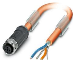
Câble préconfectionné pour bus, FOUNDATION Fieldbus (31,25 kbit/s), 3-pôles, blindé, extrémité libre, sur Connecteur femelle droit M12, détrompage: A, longueur de câble: 2 m
