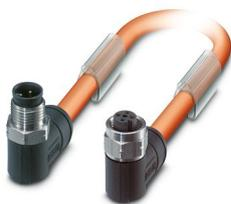
Câble préconfectionné pour bus, FOUNDATION Fieldbus (31,25 kbit/s), 3-pôles, Type de câble variable, blindé, connecteur mâle coudé M12, détrompage: A, sur Connecteur femelle coudé M12, détrompage: A, longueur de câble: Longueur au choix (0,2... 40,0 m), Molette inox
