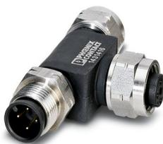
Répartiteur en T, FOUNDATION Fieldbus, PROFIBUS PA, 4-pôles, non blindé, connecteur mâle droit M12, détrompage: A, sur Connecteur femelle droit M12, détrompage: A et Connecteur femelle droit M12, détrompage: A, Répartiteur parallèle
