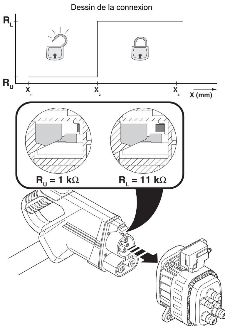
Détection pour connecteur mâle de véhicule
