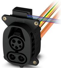
CHARX connect universal, Prise de raccordement côté véhicule, pour la recharge en courant alternatif (AC) et en courant continu (DC), CCS type 1, CEI 62196-2, CEI 62196-3, 200 A / 1000 V (DC), 80 A / 250 V (AC), Fils individuels, longueur: 11 m, actionneur de verrouillage: 12 V, 4 pôles, Montage sur les parois avant et arrière, M6, boîtiers: noir, Pour les contacts DC et AC, un cache de protection est fourni.
