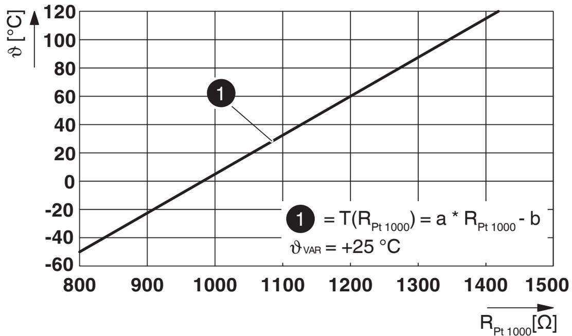
Courbe caractéristique Pt 1000 à une température ambiante de 25° C pour la surveillance de la température sur les contacts DC
