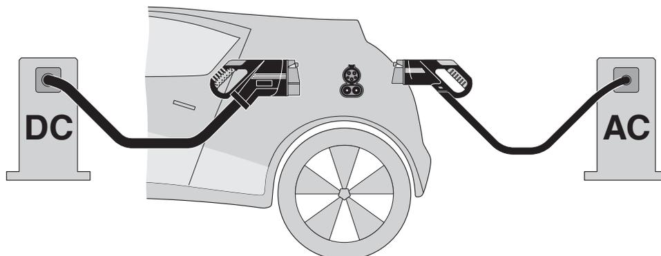
Principe du Système de Charge Combiné (CCS) - Système de charge enfichable, conforme à la norme, destiné aux véhicules, compatible à la fois avec la recharge conventionnelle en courant alternatif (CA) et avec la recharge rapide en courant continu (CC). Les deux connecteurs de charge du véhicule conviennent à l'entrée CCS du véhicule.
