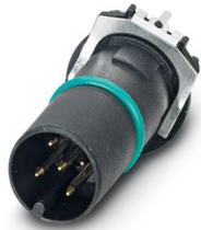
Porta-contatos, 5-pôles, Connecteur mâle, droit, M12, détrompage: A, Montage circuits imprimés, Raccordement soudé THR, Produit de remplacement selon RoHS II sans exception 6c (Pb < 0,1 %) référence : 1237428
