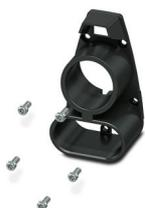
CHARX connect, Kit de réparation, Accessoires, avec cadre d'enfichage échangeable, Avec 5 vis à tête plate M4X10 et à entraînement de sécurité Torx (IPR TORX PLUS® IEC®) pour le changement du cadre d'enfichage des connecteurs de charge côté véhicule, CCS type 1, CEI 62196-3-1, SAE J1772, Montage vissé, boîtiers: noir, Changement sans vidange du fluide de refroidissement
