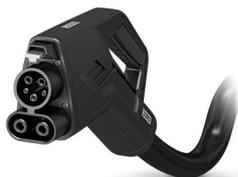
CHARX connect standard, Câble de charge DC, avec connecteur de charge côté véhicule et extrémité de câble libre, pour la charge en courant continu (DC) des véhicules électriques (VE), Avec support de connecteur de charge, avec capteurs de température analogiques, CCS type 1, SAE J1772, CEI 62196-3, 200 A / 1000 V (DC), Logo PHOENIX CONTACT, câble: 10 m, noir, droit, IMPORTANT : gestion de câbles requise le cas échéant.
