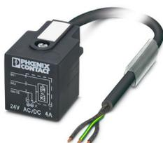
Câble pour capteurs/actionneurs, 3-pôles exempt d'halogène, extrémité libre, sur Connecteur de vanne A, avec 1 LED, câblé avec Diode zéner, longueur de câble: 10 m
