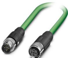
Câble de réseau, PROFINET CAT5 (100 Mbit/s), EtherCAT® CAT5 (100 Mbit/s), 4-pôles, Type de câble variable, blindé, connecteur mâle droit M12 SPEEDCONNEC, détrompage: D / IP67, sur Connecteur femelle droit M12 SPEEDCONNEC, détrompage: D / IP67, longueur de câble: Longueur au choix (0,2... 40,0 m)
