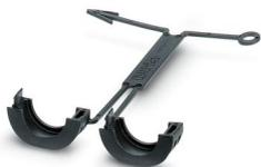
Clip de sécurité pour le côté connecteur mâle de câbles pour capteurs/actionneurs munis de connecteurs M12 et de connecteurs M12 à confectionner, pour écrous moletés de diamètre 15 mm, ou pour clé Allen de 14 mm, évite la séparation de raccords enfichables, sans outil
