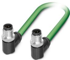
Câble de réseau, PROFINET CAT5 (100 Mbit/s), EtherCAT® CAT5 (100 Mbit/s), 4-pôles, Type de câble variable, blindé, connecteur mâle coudé M12 SPEEDCONNEC, détrompage: D / IP67, sur connecteur mâle coudé M12 SPEEDCONNEC, détrompage: D / IP67, longueur de câble: Longueur au choix (0,2... 40,0 m)
