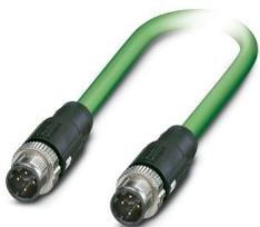
Câble de réseau, PROFINET CAT5 (100 Mbit/s), EtherCAT® CAT5 (100 Mbit/s), 4-pôles, Type de câble variable, blindé, connecteur mâle droit M12 SPEEDCONNEC, détrompage: D / IP67, sur connecteur mâle droit M12 SPEEDCONNEC, détrompage: D / IP67, longueur de câble: Longueur au choix (0,2... 40,0 m)
