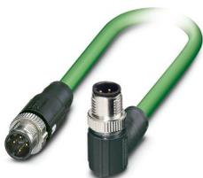
Câble de réseau, PROFINET CAT5 (100 Mbit/s), EtherCAT® CAT5 (100 Mbit/s), 4-pôles, Type de câble variable, blindé, connecteur mâle droit M12 SPEEDCONNEC, détrompage: D / IP67, sur connecteur mâle coudé M12 SPEEDCONNEC, détrompage: D / IP67, longueur de câble: Longueur au choix (0,2... 40,0 m)
