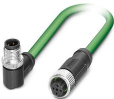
Câble de réseau, PROFINET CAT5 (100 Mbit/s), EtherCAT® CAT5 (100 Mbit/s), 4-pôles, Type de câble variable, blindé, connecteur mâle coudé M12 SPEEDCONNEC, détrompage: D / IP67, sur Connecteur femelle droit M12 SPEEDCONNEC, détrompage: D / IP67, longueur de câble: Longueur au choix (0,2... 40,0 m)
