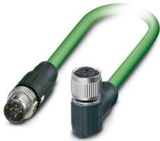
Câble de réseau, PROFINET CAT5 (100 Mbit/s), EtherCAT® CAT5 (100 Mbit/s), 4-pôles, Type de câble variable, blindé, connecteur mâle droit M12 SPEEDCONNEC, détrompage: D / IP67, sur Connecteur femelle coudé M12 SPEEDCONNEC, détrompage: D / IP67, longueur de câble: Longueur au choix (0,2... 40,0 m)
