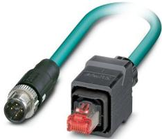
Câble de réseau, Ethernet CAT5 (100 Mbit/s), Ethernet CAT5 (100 Mbit/s), 4-pôles exempt d'halogène, blindé, connecteur mâle droit M12, détrompage: D / IP65, sur connecteur mâle droit RJ45 / IP20, longueur de câble: 53 m
