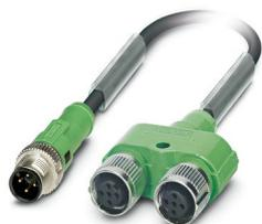
Câble pour capteurs/actionneurs, 4-pôles, PUR exempt d'halogène, gris-noir RAL 7021, connecteur mâle droit M12 SPEEDCONNec, détrompage: A, sur Connecteur femelle droit M12 SPEEDCONNec, détrompage: A et Connecteur femelle droit M12 SPEEDCONNec, détrompage: A, longueur de câble: 3 m
