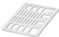
Repère pour conducteur, Planche, blanc, vierge, repérable avec : BLUEMARK ID COLOR, BLUEMARK ID, BLUEMARK CLED, PLOTMARK, CMS-P1-PLOTTER, type de montage: insertion, plage de diamètre de câble: 1,5 ... 35 mm, surface utile: 23 x 4 mm, Nombre d'étiquettes: 24
