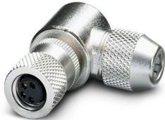
Connecteur, Universel, 4-pôles, blindé, connecteur femelle coudé M8, détrompage: A, Raccordement soudé, matériau de la molette: Laiton, nickelé, diamètre extérieur du câble 3,5 mm ... 5 mm
