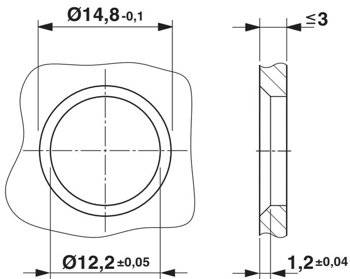
Découpe du boîtier pour connecteurs encastrables M12 en deux éléments, avec raccordement THR et à soudure à vague, variante 1
