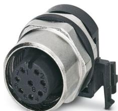
Connecteur d'appareil face arrière, 8-pôles, connecteur femelle, coudé, M12-SPEEDCONN, détrompage: A, Montage face arrière, M12 x 1, Picots de soudage, Produit de remplacement selon RoHS II sans exception 6c (Pb < 0,1 %) référence : 1239643
