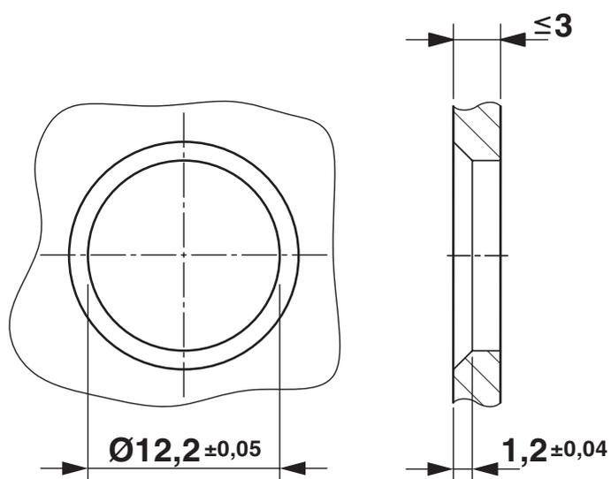
Découpe du boîtier pour connecteurs encastrables M12 en deux éléments, avec raccordement THR et à soudure à vague, variante 2
