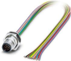
Connecteur d'appareil face arrière, Universel, 12-pôles, Connecteur mâle, droit, M12-SPEEDCONNEC, détrompage: A, sur extrémité libre, Montage face arrière, Cordons individuels, longueur de câble: 0,5 m, 0,34 mm<sup>2</sup>, Cordon TPE, Produit de remplacement selon RoHS II sans exception 6c (Pb < 0,1 %) référence : 1239647
