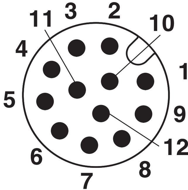
Brochage connecteur mâle M12, 12 pôles, détrompage A, vue côté mâle
